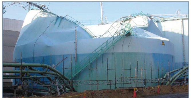
الشكلان 1 و2: الصهريج التالف والأنابيب الممتدة تحت الأرض (المصدر: تقرير لجنة التحقيق السويدية).
