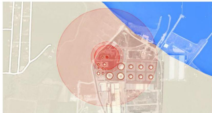
Abbildung 6: RAPID-N-Ergebnis für die Freisetzung eines brennbaren Stoffs aus einem Lagertank unter Erdbebeneinwirkung.
