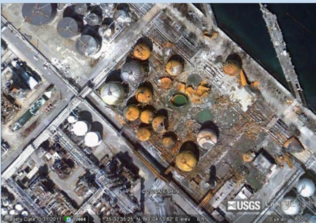
ნახ. 4: თხევადი ნახშირწყალბადიანი აირის შემცველი ცისტერნები ჩიხას ნავთობგადამამუშავებელ ქარხანაში მიწისძვრის შედეგად გამოწვეული ხანძრისა და აფეთქების შემდეგ (2012 წ., გუგლი, ზენრინი)
