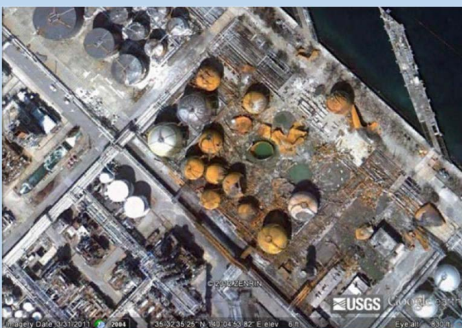
Figura 4: Parcul de rezervoare GPL de la rafinăria Chiba, în urma cutremurului, care a declanșat incendii și explozii (2012 Google,
