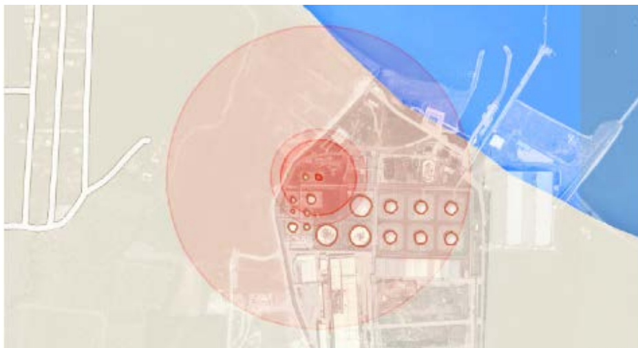
Figura 6: Imaginea generată de RAPID-N la eliberarea substanțelor inflamabile dintr-un rezervor, în urma unui cutremur.
