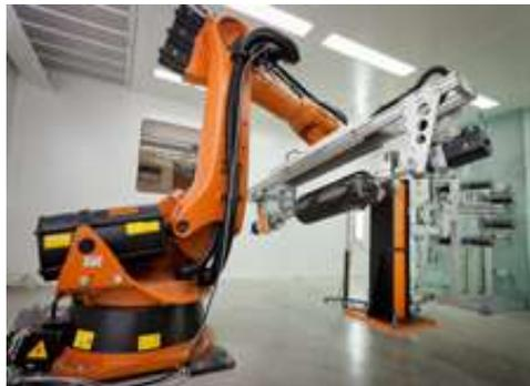
Robot enroulement filamentaire
