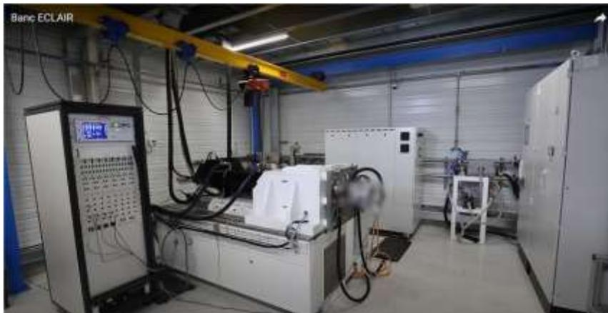
*Banc « ECLAIR » : Réalisation interne d'un banc de caractérisation de moteur électrique (250kW ; jusqu'à 21000rpm ; jusqu'à 500Nm), associé à un simulateur batterie 250kW / 1000V / 1000A.*
