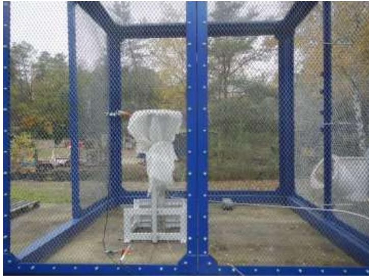
Figure 39 : Cage pour la rétention des fragments
