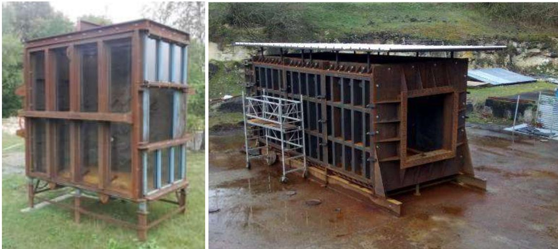
Figure 40 : Chambres d'explosion (utilisées par exemple pour qualifier des dispositifs de protection (événements d'explosion))
